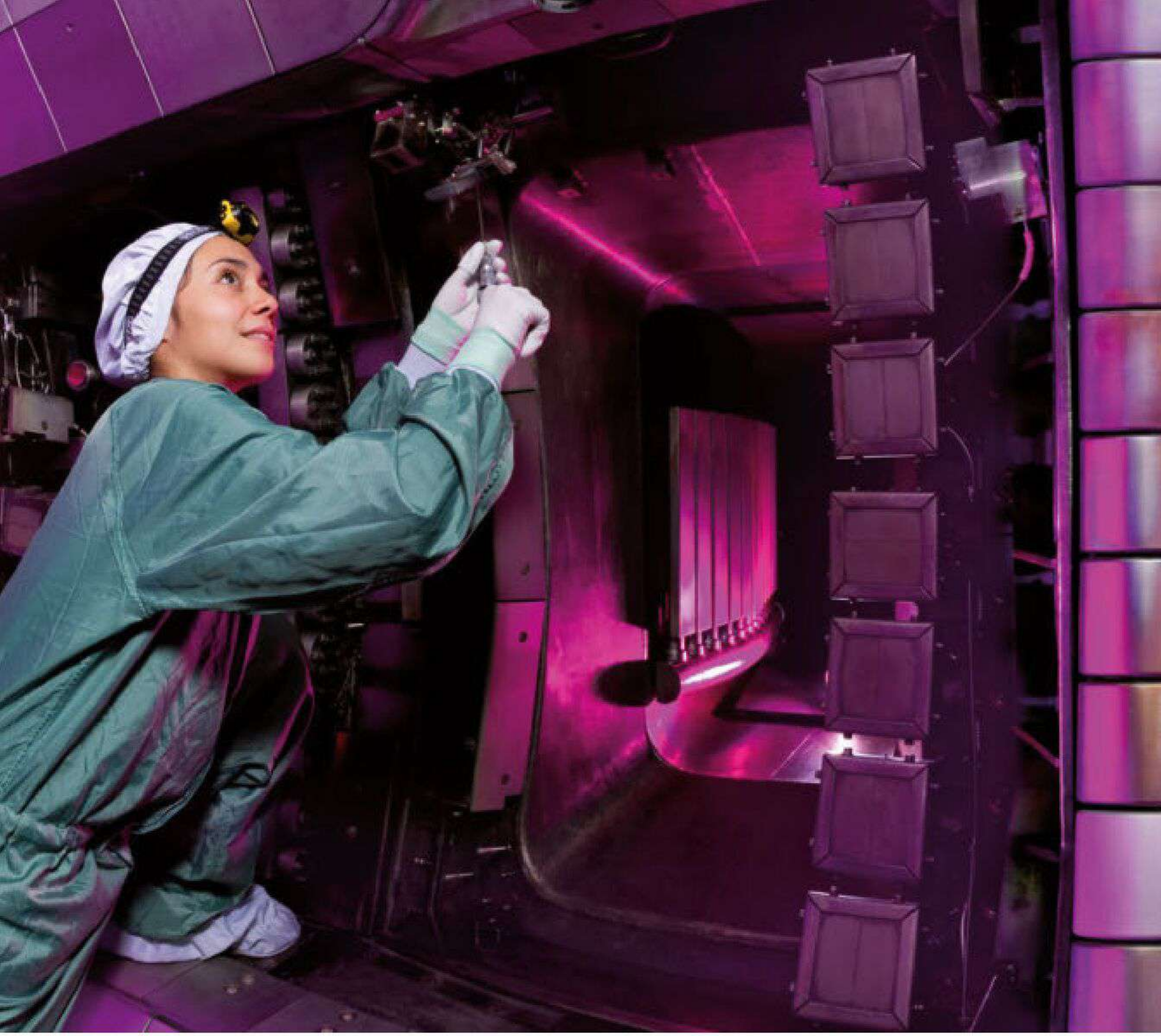
Links: Wartungsarbeiten im Inneren der Plasmakammer von Asdex Upgrade, einer Fusionsforschungsanlage am Max-Planck-Institut für Plasmaphysik in Garching bei München. Die Wissenschaftlerin Athina Kappatou kalibriert Geräte, die während des Betriebs die Eigenschaften des heißen Teilchen-Gemischs messen. Oben: per CCD-Kamera festgehaltene Plasma-Entladung in dem Reaktor.
