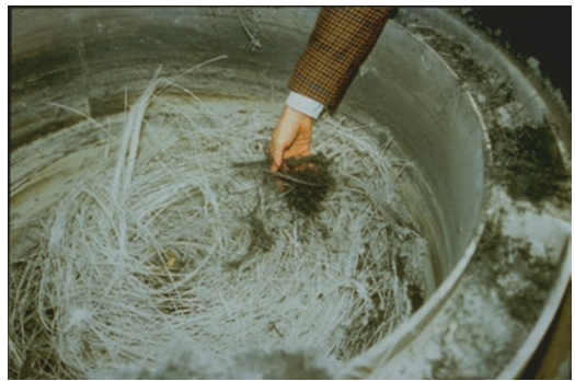
■ Abb. 9.56 Bruchbild eines Verbundrotors [25]
