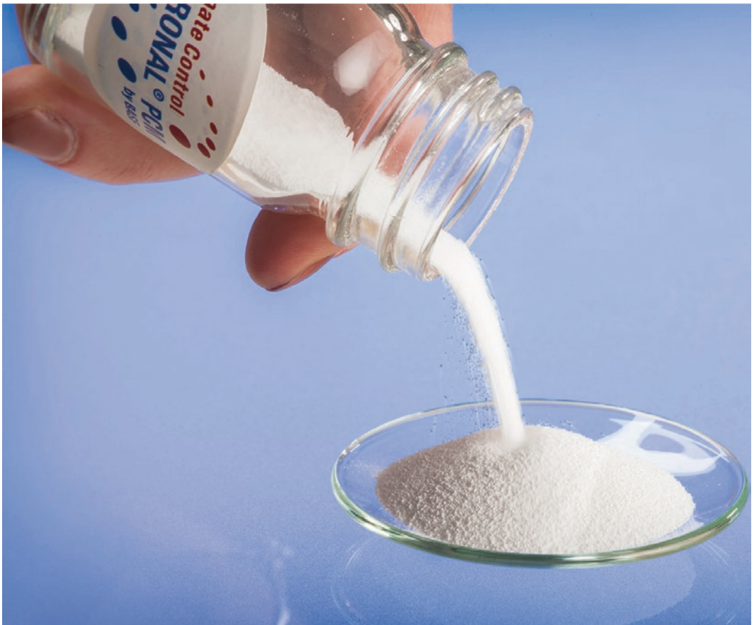
Abb. 10.25 Mikroverkapseltes Paraffin des Produkts Micronal® PCM (Quelle: BASF SE)
