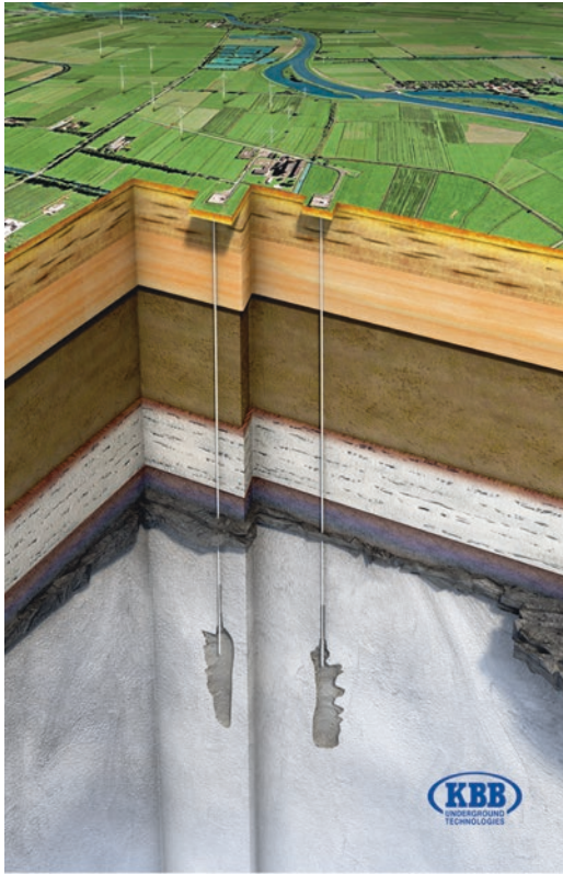
■ Abb. 8.49 Gasspeicherkavernen (Quelle: KBB UT)
