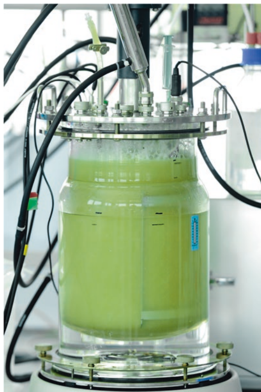
■ Abb. 8.31 Rührkesselreaktor zur biologischen Methanisierung mit Archaea-Mikroorganismen (Quelle: Electrochaea GmbH)
