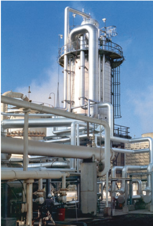
■ Abb. 8.37 Methanol-Reaktor der Linde AG (Quelle: Linde AG)
