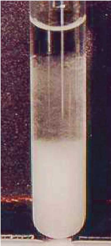
■ Abb. 10.23 Separiertes Glaubersalz ( \text{NaSO}_4 \cdot 10 \text{H}_2\text{O} ), oben: gesättigte wässrige Lösung, Mitte: Glaubersalz, unten: wasserfreies Natriumsulfat
