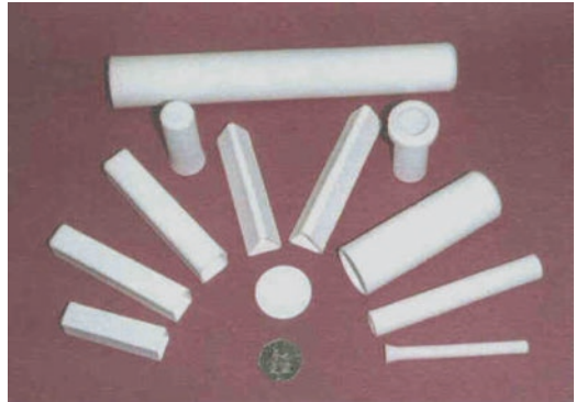
Abb. 7.57 Darstellung von Bauformen des keramischen Festkörperelektrolyten des Unternehmens Ionotec
