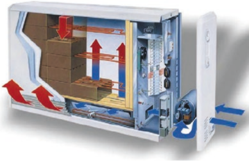
■ Abb. 10.10 Schnitt durch eine Speicherheizung
