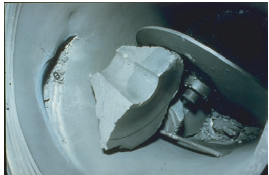
■ Abb. 9.55 Bruchbild eines Stahlrotors [25]
