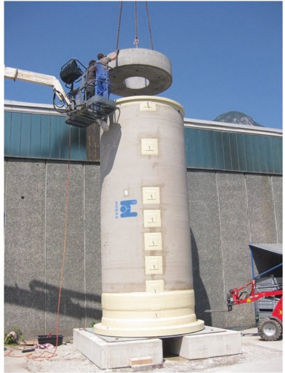
▣ Abb. 9.71 Real existierender Modellversuch eines Lageenergiespeichers vom Typ »Powertower 2« an der Universität Innsbruck, Österreich.
