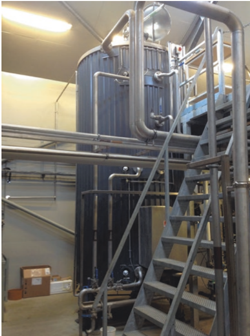
■ Abb. 14.31 Rührkesselreaktor mit einem Fassungsvermögen von 10.000 l für die biologische Methanisierung in Dänemark, realisiert und betrieben von Electrochaea.dk (Quelle: Electrochaea.dk)
