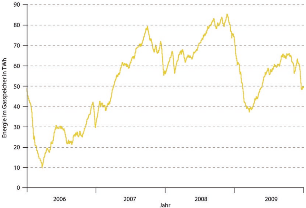
▣ Abb. 3.22 Füllstand des Gasspeichers über die betrachteten Wetterjahre 2006–2009, nach [43]
