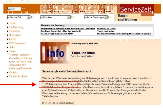
In **Wahrheit** spart ein 1qm-Solarkollektor in Deutschland **lediglich 300 kWh bis 350 KWh** Nutzwärme im Jahr ein.
